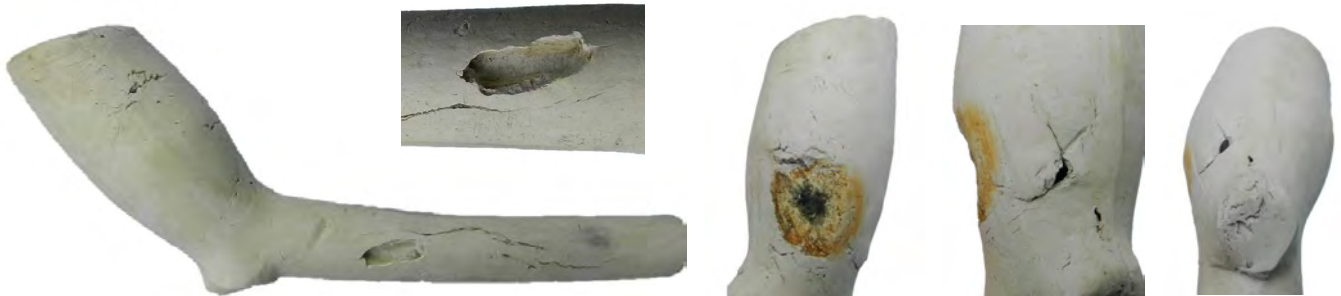
Afb. 33. Dubbelconisch model, misbaksel met scheefstaande kop, scheuren in steel en kop, gat in steel door meegebakken organische verontreiniging, meegebakken en geoxideerde verontreiniging in ketel, te ver doorgestoken weijer ongeglasd, ongemerkt, hoogte 4 cm. Zeeland(?), 1635-1650 (ZEE-ALG).
